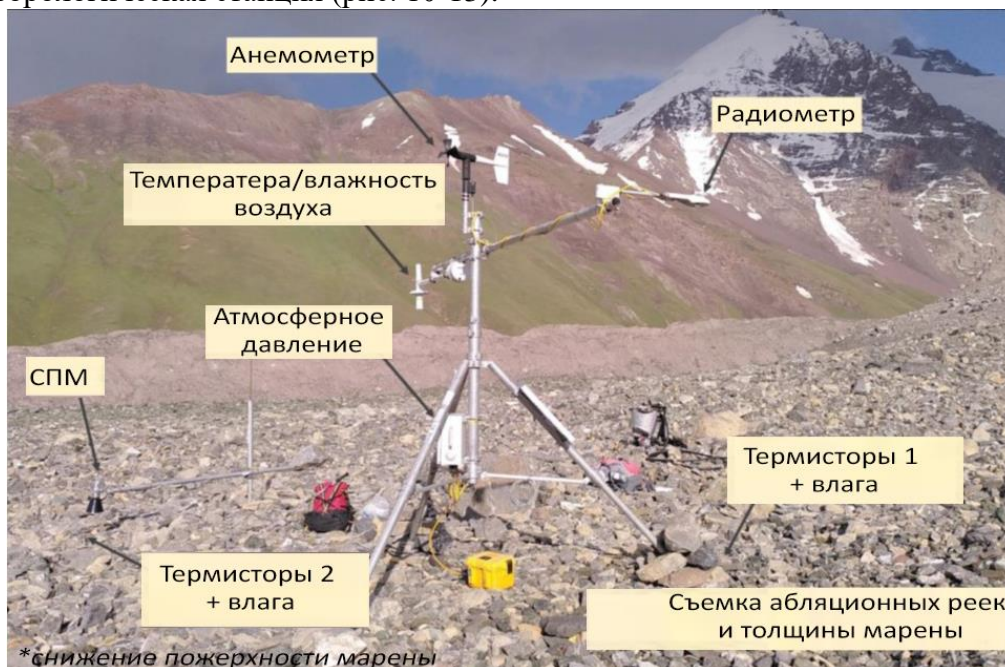
Фото 10. Многофункциональная метеорологическая станция на леднике Кызылсу (3700 м над ур. моря)
