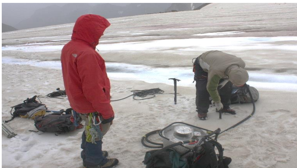
Фото 7. Бурение ледника с помощью термобура для установления реперов
